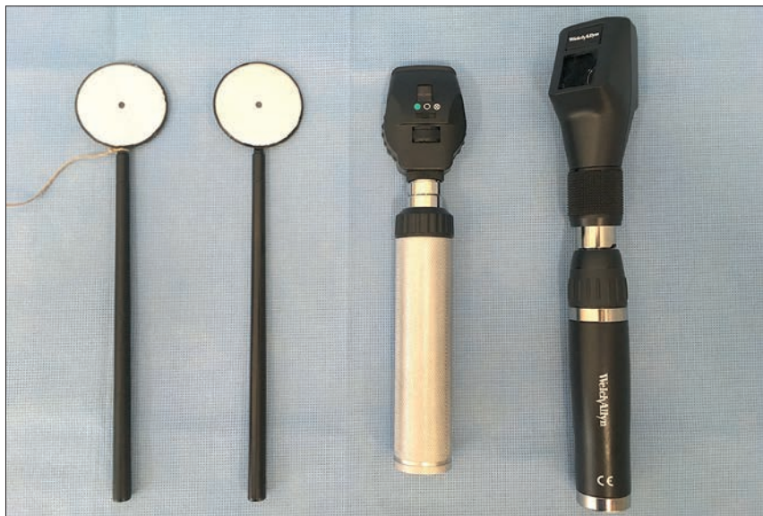
Ryc. 1. Przyrządy, które można wykorzystać do badania refrakcji metodą skiaskopii. Od lewej: zwierciadło wklęsłe i płaskie, oftalmoskop bezpośredni, skiaskop
