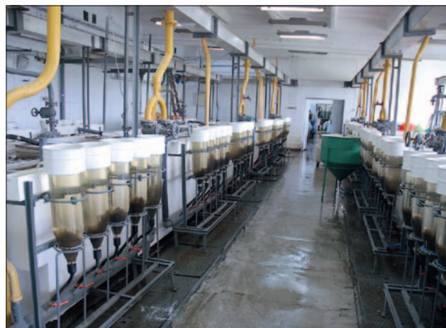
Ryc. 4. Fragment wylęgarni, baterie słoje Weissa
