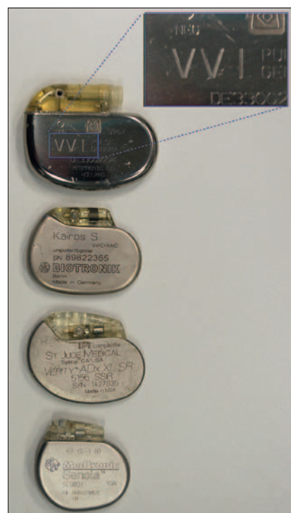
Ryc. 2. Stymulatory jednojamowe różnej generacji z wyeksponowanym kodem stymulatora
