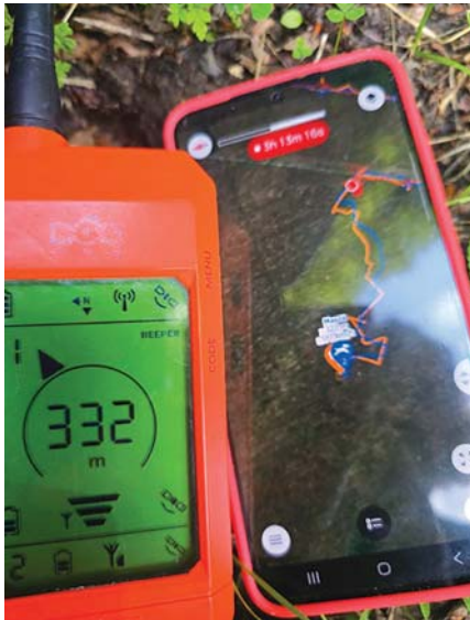
Rycina 4. Nadajniki GPS w obrozach psów pozwalają na stałe śledzenie dystansu do psa oraz zapisują całą trasę zwierzęcia.
